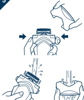
5. Снимите бритвенную головку и держите кнопку выключателя нажатой в течение 2 секунд, чтобы активировать турборежим для очистки бритвы звуковой вибрацией, и промойте под проточной водой лезвия, а затем прочистите сетку проточной водой.
