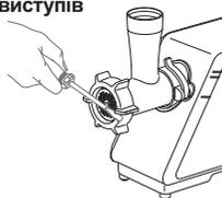
Для полегшення знімання решітки вставте викрутку поміж решіткою та сталевим корпусом, як це показано на малюнку та підніміть її.
